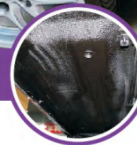
底盘防腐蜡应用 Chassis wax application
